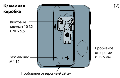
Степень защиты IP: 54 (с сальником кабельным)
