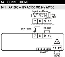
Probe: Pt100= 7 - 9 (8); Thermocouple J, K, S = 7(+); 9(-) 24Vac/cd supply: 11-12
